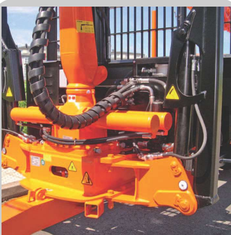
Depósito y enfriador protegido (sólo en remolques con grúa).
