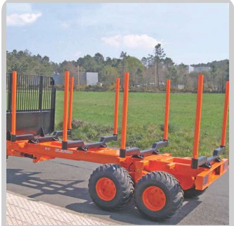
4 puentes de carga atornillados de dos posiciones (sólo chasis Pirineos).
