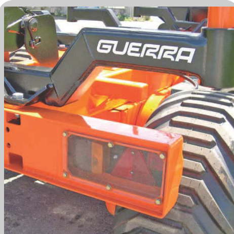
Protección reforzada de la iluminación posterior. Rear lights reinforced protection.
