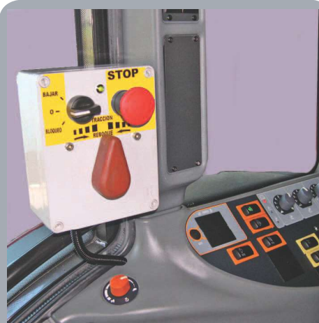
Bloqueo de diferencial (de serie en R16). Differential lock (standard on R16).
