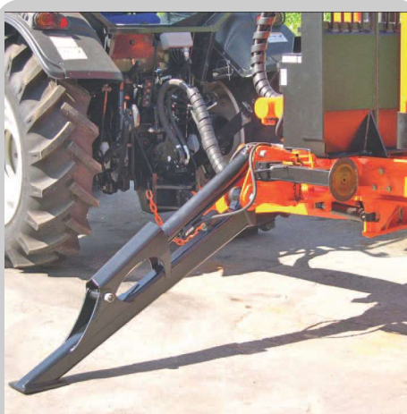
Estabilizadores abatibles y depósito de aceite (sólo en remolques con grúa).
