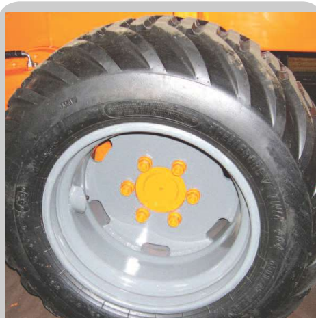
Protección de válvulas de inflado en ruedas y llantas reforzadas. Forest tyres with reinforced rims and valve guards.
