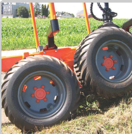
Tracción a las 4 ruedas con eje oscilante y frenos de disco a las 4 ruedas.
